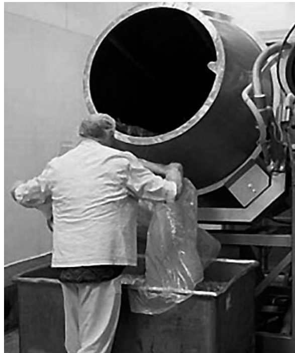
Tumbling: Kødet ligger i neutralmarinade i en beholder, som vender rundt og tumbler kødet (Foto: Mads Armgaard, Danish Meat Association)
