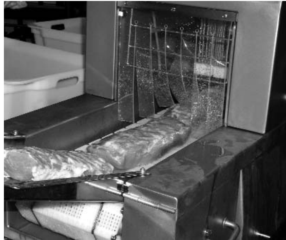
Stiksaltning: Kødet kommer under stemplet, hvor nålene sprøjter neutralmarinade ind i det (Foto: Mari Ann Tørngren, Slagteriernes Forskningsinstitut, Danish Meat Association)
